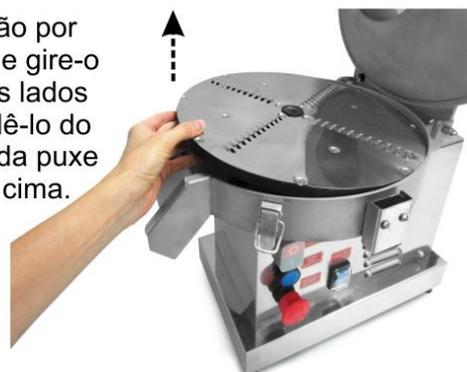
• **Montagem do disco:** O procedimento de montagem é o inverso da desmontagem. Ao remontar o disco, já escolha o modelo de disco que se adequa ao processo que necessita no momento. Verifique os modelos de discos no item 2.1 (Principais Componentes).
