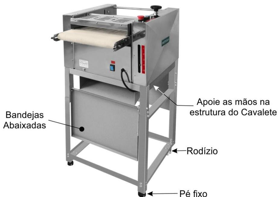
Estando a máquina posicionada no local de trabalho adequado, abaixe a máquina encostando os os pés fixos no chão, impossibilitando a movimentação dos rodízios.
