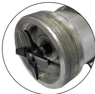
Monte a faca cruzeta com o fio da lâmina para frente
