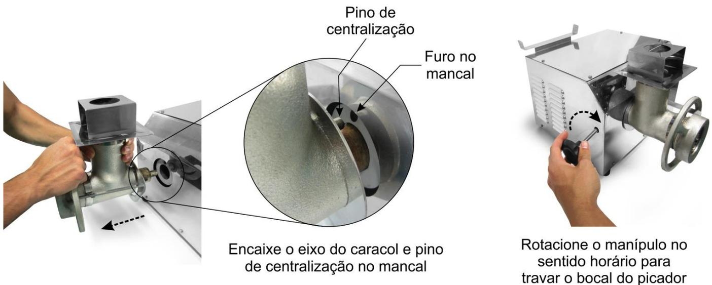
Deve-se fixar todas as peças perfeitamente para que não ocorra travamento ou desgaste, e para que seja garantida a segurança do operador. Caso alguma peça não tenha sido encaixada corretamente, repita a operação e não obtendo êxito, contate a assistência técnica.
