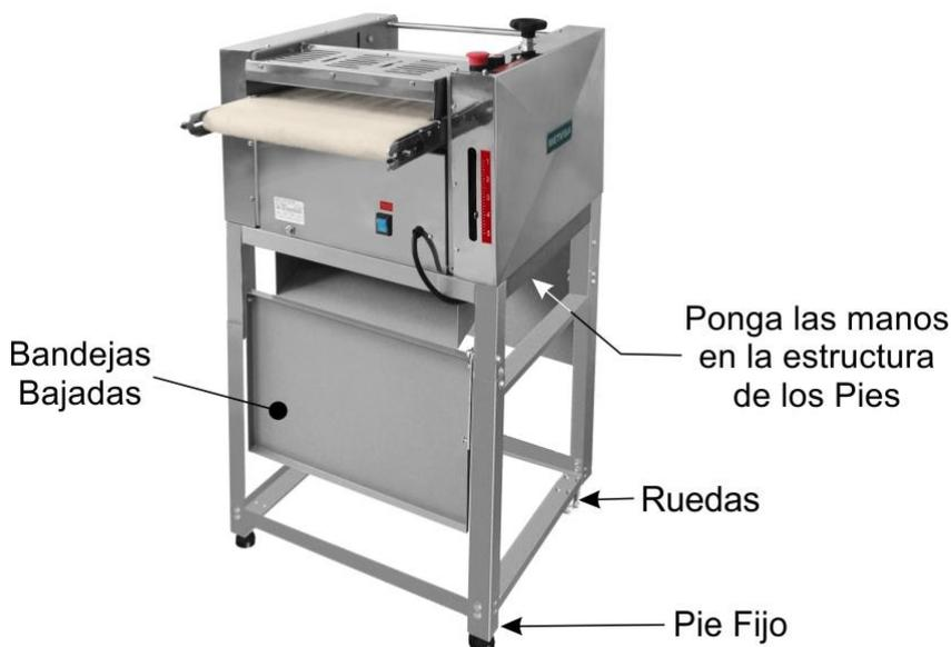
Cuando el equipo esté posicionado en el sitio adecuado, baje el equipo tocando los pies fijos en el piso, previniendo el movimiento de las ruedas.
