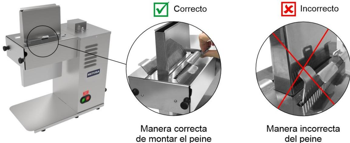
Montar todas las piezas a la perfección para que se garantice la seguridad del operador y el correcto funcionamiento del equipo. Si alguna pieza no está firme, es posible que no se haya colocado correctamente. En este caso, repita la operación y si no tiene éxito, póngase en contacto con la asistencia técnica.
