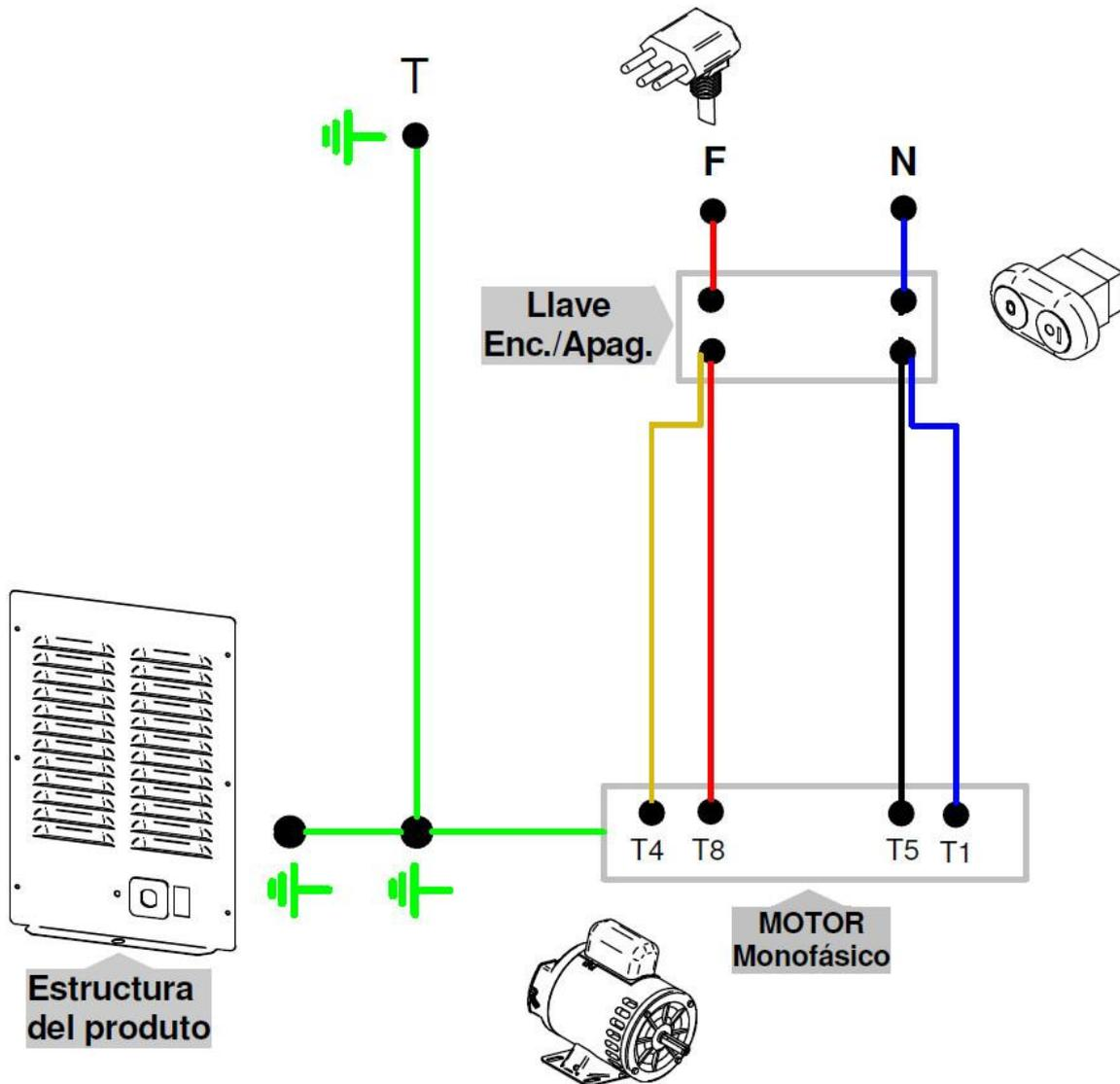
**NOTA:** Motor con doble sentido de giro. Para invertir la rotación, reemplace T5 con T8.
