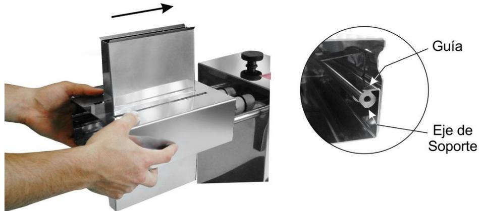
Cuando vuelva a montar los rodillos en el cajón, coloque la ranura del rodillo en el interior del cajón. Tenga en cuenta que en el rodillo 01 hay un disco y debe montarse contra la placa del cajón. Otra atención que debes tener está relacionada con la primera hoja del rodillo 02. La hoja tendrá que estar detrás del disco del rodillo 01, como se muestra en la imagen siguiente.
