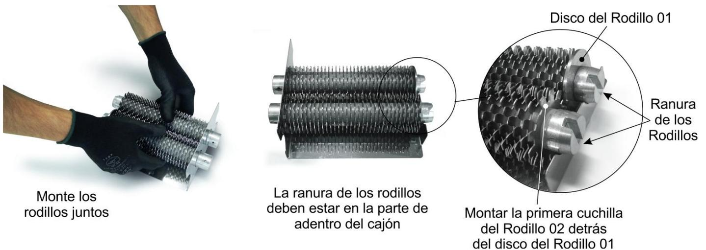
Después de ensamblar el cajón dentro del protector de rodillos, gire los rodillos hasta que la ranura encaje en el hombro de los ejes de engranajes. Para comprobar que los rodillos están asentados correctamente, gire la manija de reversión y observe si los dos rodillos están girando.
