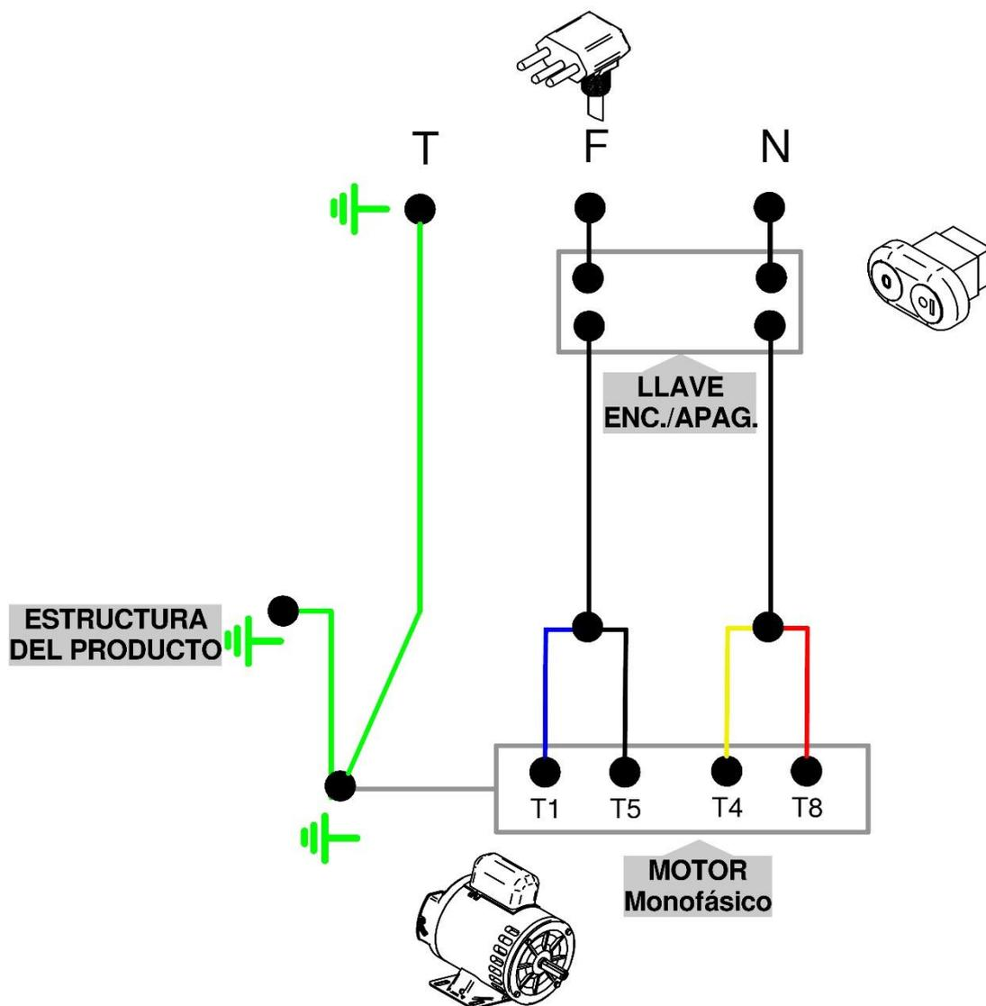
**NOTA:** Motor con doble sentido de giro. Para invertir la rotación, reemplace T5 con T8.
