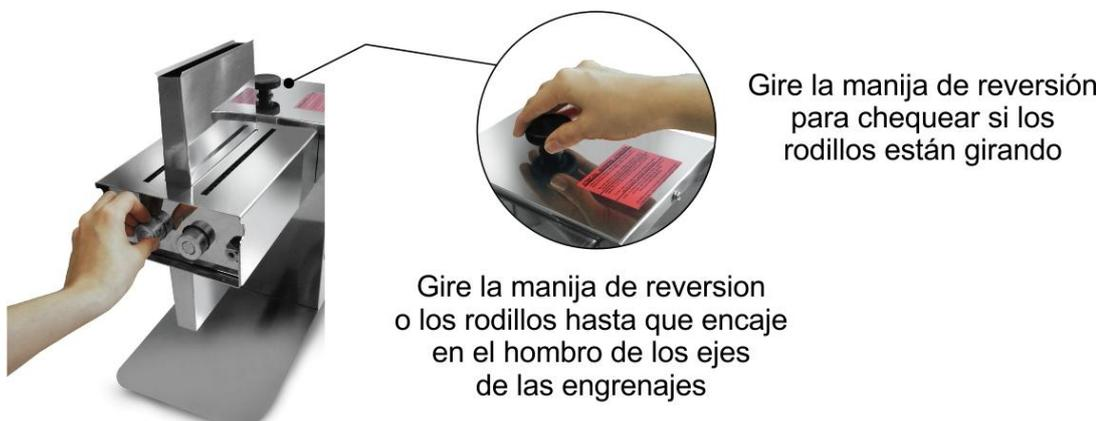
Con los rodillos colocados, montar la tapa frontal fijándola con las dos manijas, y la protección de la manija de inversión con las tuercas. Finalmente coloque el peine con el mango hacia afuera.
