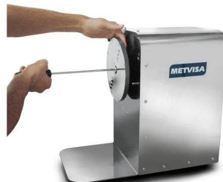
• **Montaje:** El procedimiento de montaje es inverso al de desmontaje. Al volver a montar el disco, elija el modelo de disco que se adapte al proceso que necesita en ese momento, colóquelo en el eje del
