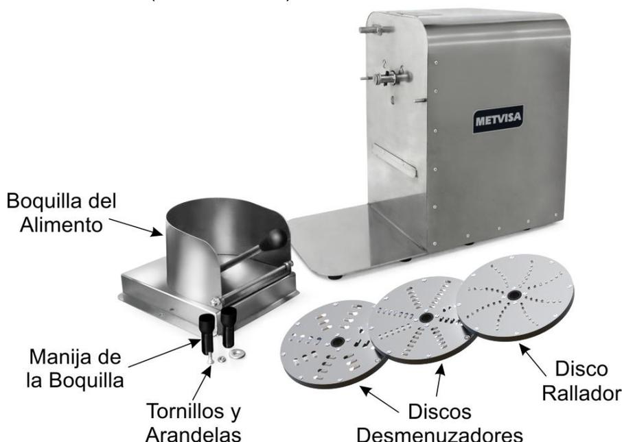
Vea el procedimiento de desmontaje y montaje que se describe a continuación:
