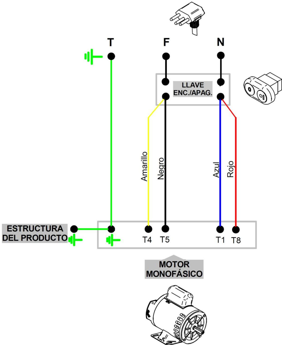
NOTA: Motor con doble sentido de giro. Para invertir la rotación, reemplace T5 con T8.
