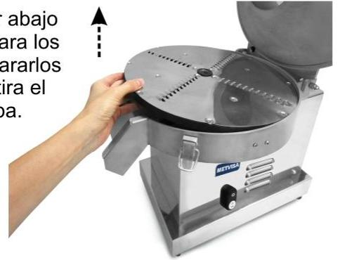
• **Montaje del disco:** El procedimiento de montaje es inverso al desmontaje. Al volver a montar el disco, elija el modelo de disco que se adapte al proceso que necesita en este momento. Verifique los modelos de disco en el ítem 2.1 (Componentes principales).
