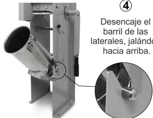
• **Montaje:** El procedimiento de montaje es el procedimiento inverso del desmontaje. Monte el barril en el encaje de las laterales del equipo. Bloqué el barril usando el manipulador. Al remontar el embudo en la tuerca, escoja el modelo de embudo que mejor se adecua al proceso que será usado en el momento y rosque la tuerca en la boquilla.
