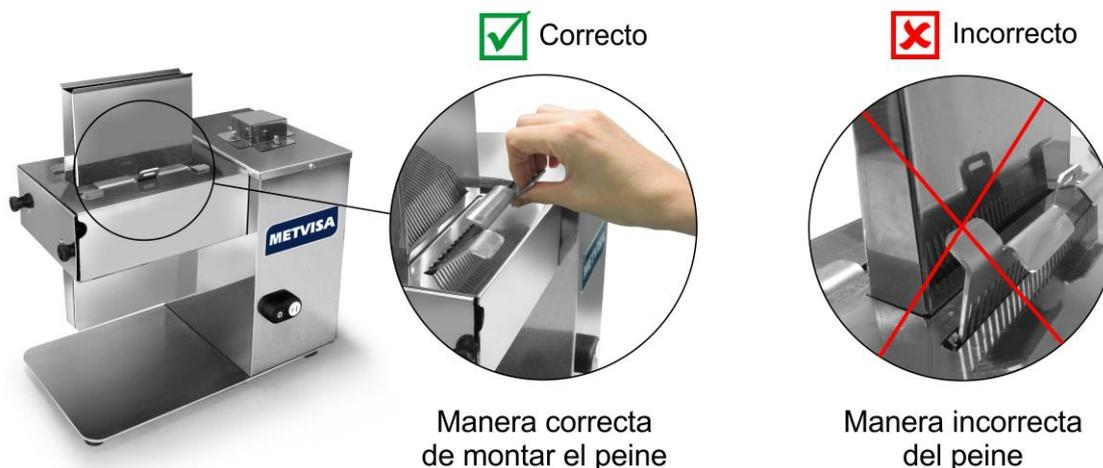
Montar todas las piezas a la perfección para que se garantice la seguridad del operador y el correcto funcionamiento del equipo. Si alguna pieza no está firme, es posible que no se haya colocado correctamente. En este caso, repita la operación y si no tiene éxito, póngase en contacto con la asistencia técnica.
