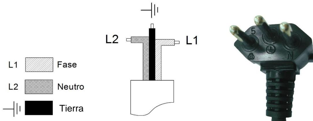
Todos los modelos de los equipos descritos en este manual son monofásicos y tienen un solo voltaje, es decir, 110 V, 127 V o 220 V. Si es necesario cambiar el voltaje de su equipo, comuníquese con el fabricante o un distribuidor autorizado.
