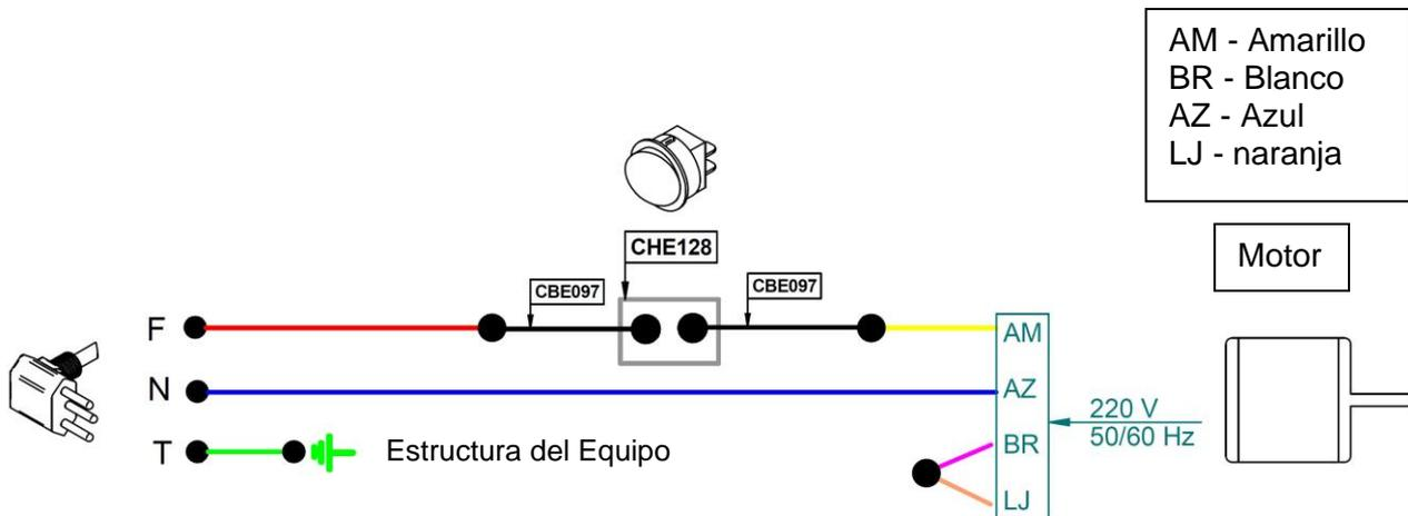
**ATENCIÓN:** La conexión a tierra varía según el tipo de enchufe. Para la instalación eléctrica, observe la normativa vigente en el país, especialmente en lo que respecta a la conexión a tierra (si aplica).
