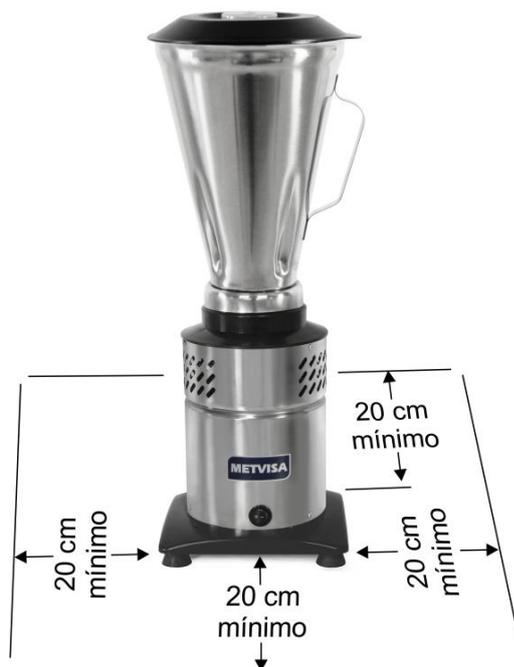
Para garantizar el correcto funcionamiento y seguridad, se debe posicionar el aparato en un ambiente ventilado y sobre una superficie de apoyo suficientemente amplia, bien nivelada, seca y estable, lejos de fuentes de calor y de grifos de agua, y a una altura media de 80 cm. Instale su aparato dejando una distancia de al menos 20 cm alrededor de él, de forma que tenga espacio suficiente para la realización de inspección, mantenimiento, limpieza y uso.
