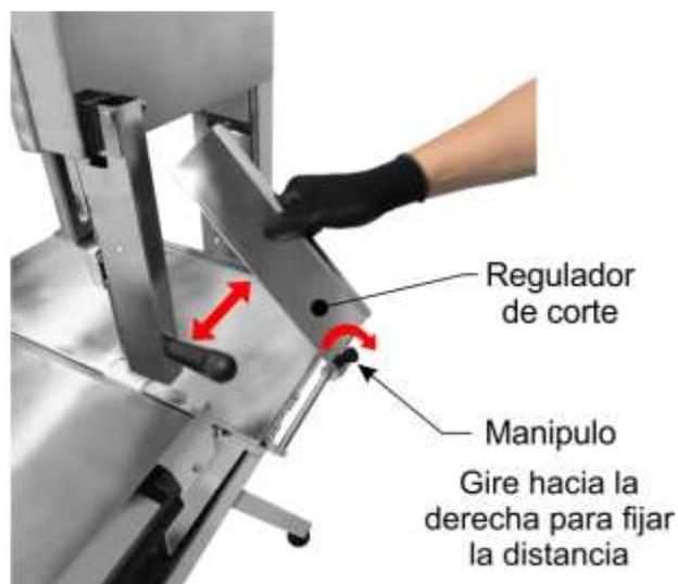
3. Ajuste la distancia entre la protección de la cuchilla y el alimento para el área expuesta de la cuchilla sea lo necesario para hacer el corte. Para mover la protección hacia arriba o hacia abajo, gire hacia la derecha el manipulador cerca del guía. Para fijar la distancia, gire hacia la derecha;
