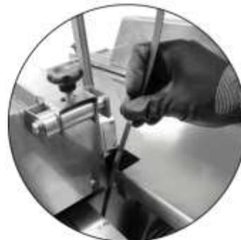
10. Retire la cuchilla pasándola por la ranura entre la mesa fija y la mesa móvil, y desciendo de la protección inferior de la cuchilla;
