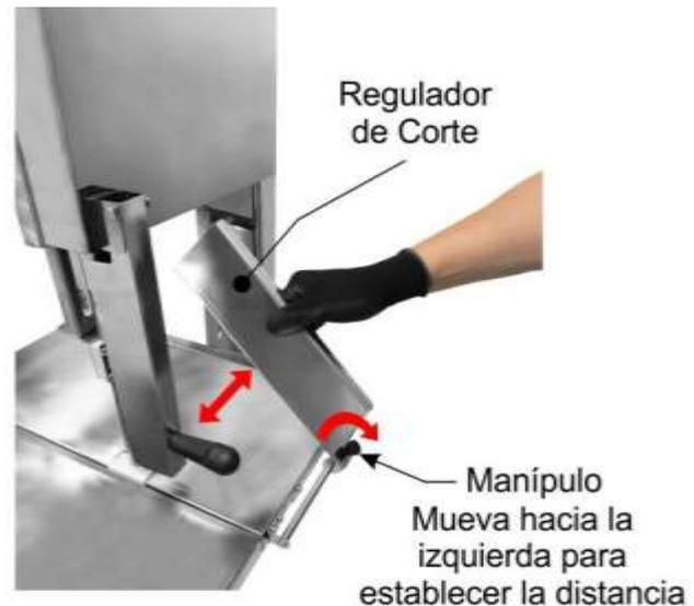
4. Ajuste la distancia entre la protección de la lámina y el alimento para que el área expuesta de la lámina sea lo necesario para realizar el corte. Para mover la protección para arriba o para abajo, basta girar a la izquierda el manipulador cerca del guía. Para fijar la distancia, gire hacia la derecha;
