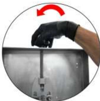
6. Gire el manipulador del estirador hacia la izquierda para aflojar la lámina;
