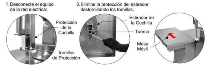
Elimine la protección de la cuchilla destornillando los tornillos:
