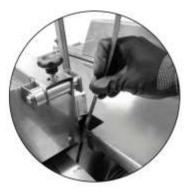
Remova la cuchilla por la abertura entre la mesa fija y la mesa móvil, evitando la protección inferior de la cuchilla;
