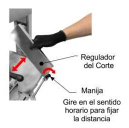
Ajuste la distancia entre la protección de la cuchilla y el alimento para que la área exposta de la cuchilla sea solamente el necesario para hacer el corte. Para movimentar la protección hacia arriba o hacia abajo, gire la manija en sentido antihorario proximo a la guía. Para fijar la distancia, gire en el sentido horario.
