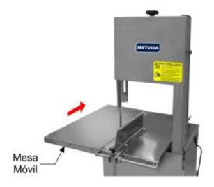
Con la mano derecha, retire la rebanada detrás de la cuchilla, evitando el contacto con el área de corte. Apile las rebanadas en la mesa fija;
