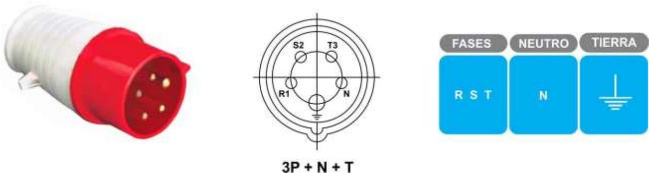
El procedimiento de mantenimiento del cable de alimentación y/o enchufe del equipo debe ser realizado por un agente autorizado o persona cualificada. Este personal, al reensamblar estos componentes y conectar los puntos, también podrá tomar como referencia las marcas existentes en el interior del tapón, en su región plástica.
